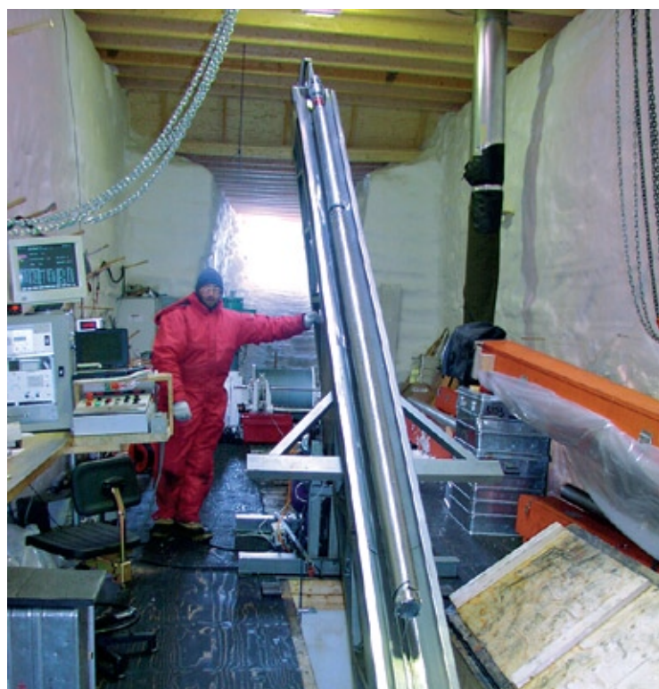
NGRIP lejren i midnatssolen - artiklens forfatter i borehallen – boret på vej til at blive sænket ned i hullet - og en iskerne fra dybet af den grønlandske iskappe. Boret er ti meter langt og kan hente tre meter iskerne op ad gangen. Iskernen har en diameter på ti centimeter.
